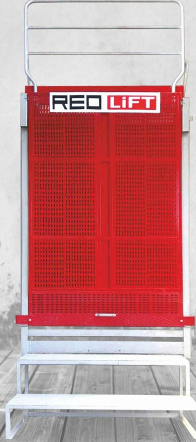
**Kramiyer dişli mekanizması üzerinde üst seviye güvenlikle çalışır. Kat durak mekanizması elektrik panosundan ayarlanarak istenilen katlarda durması sağlanır. Kolay sökülüp kolay montaj yapılır. Dış cephelere monte edilebildiği gibi, asansör kurulacak bina içi şaftlarda monte edilebilir. İnşaat halindeki binalarda binaya kat eklendikçe asansöründe yükseltmesi yapılabilir.**
